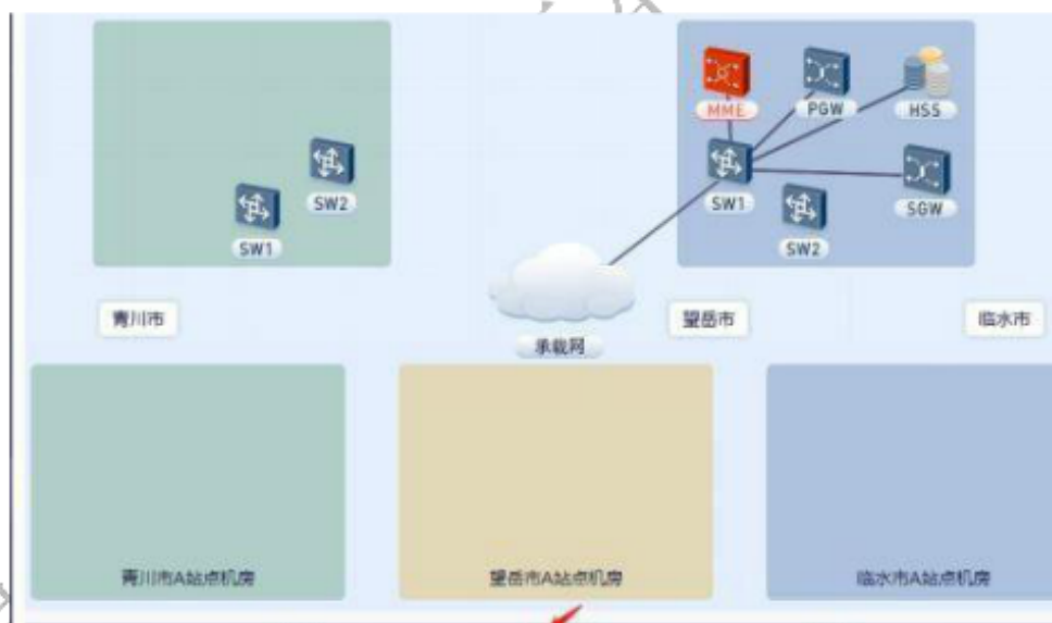
核心网设备调试完成图
